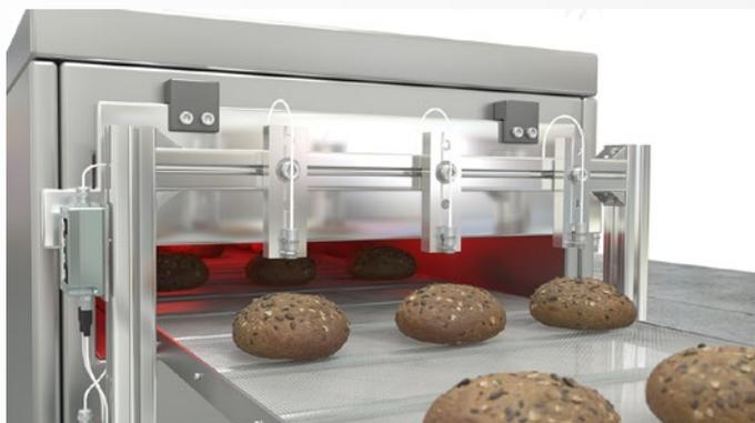
thermoMETER UC 센서를 활용한 제과·제빵 온도 측정
