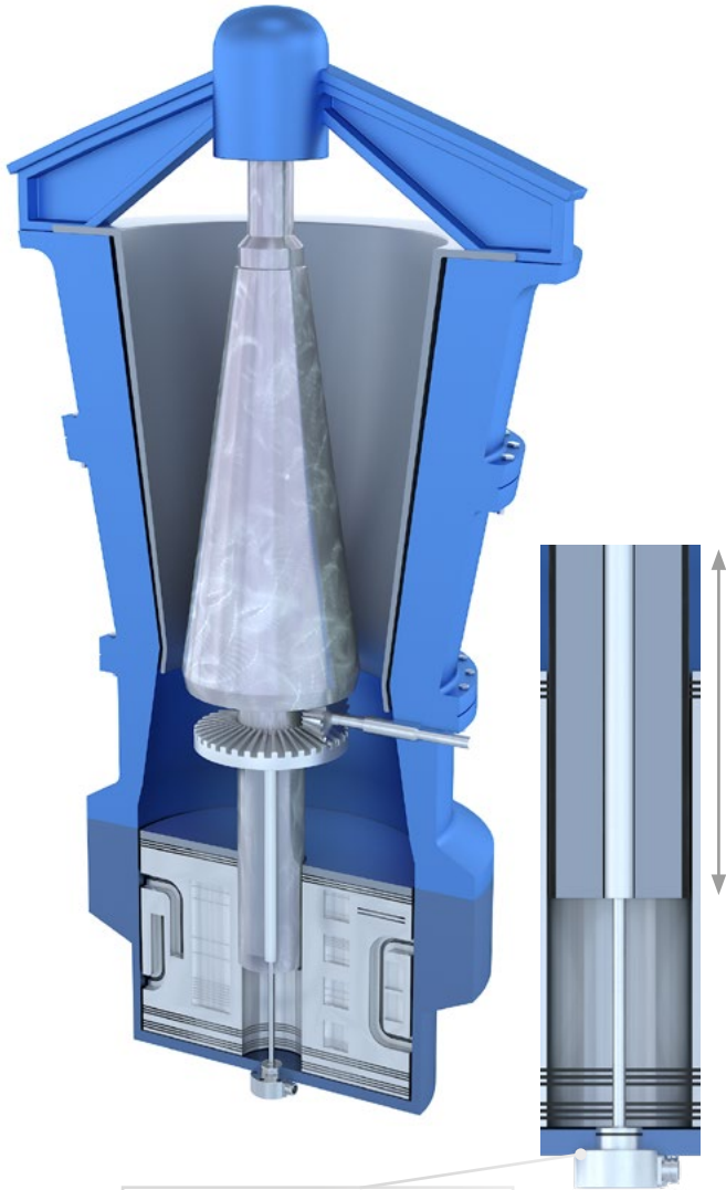
EDS-F: 파쇄 장비 내 그라인딩 휠의 고정밀 측정
